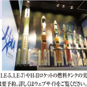
宇宙開発展示室では、角田宇宙センターで研究開発してきた実物のロケットエンジンや複合サイクルエンジンなどと共に、各研究の内容について説明したパネルなどを展示しています。また、「失敗から学ぶ」をテーマに、1999年に打ち上げに失敗し、海底から引き上げたH-IIロケット8号機のLE-7エンジンを展示しています。屋外には大型液体ロケットエンジン(LE-5、LE-7)やH-IIロケットの燃料タンクの実物なども展示しております。※団体見学(15~20名)は要予約。詳しくはウェブサイトをご覧ください。
